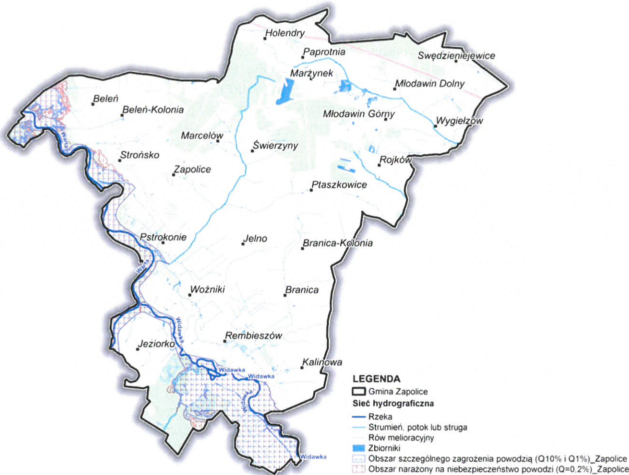
Rysunek 10. Zasięg obszarów szczególnego zagrożenia powodzią oraz obszarów narażonych na niebezpieczeństwo powodzi na podstawie map zagrożenia powodziowego (2022)
